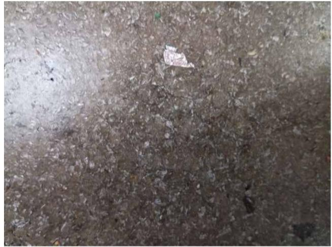
*Figura 11: Plancha de material triturado y extrusionado*
