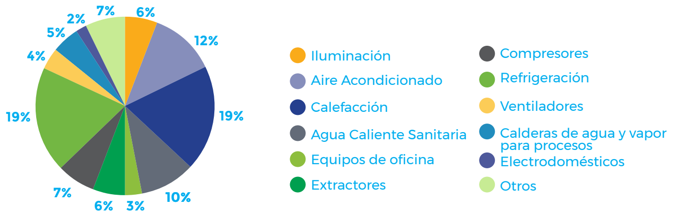
Figura 3b: Distribución de potencia eléctrica
