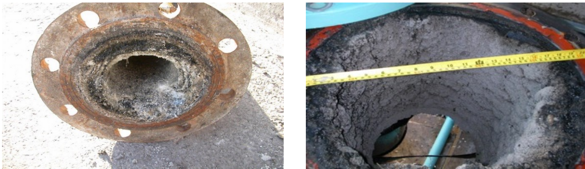
Figura 24: Precipitación de estruvita en sistemas de cañería
